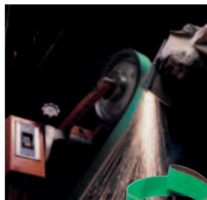
Грубое шлифование нержавеющей стали
