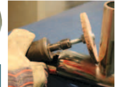
Удаление сварного шва в труднодоступных местах
