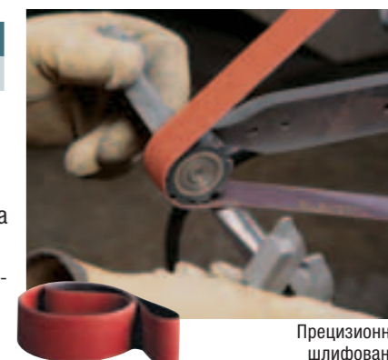
Шлифовка и восстановление заводской риски
